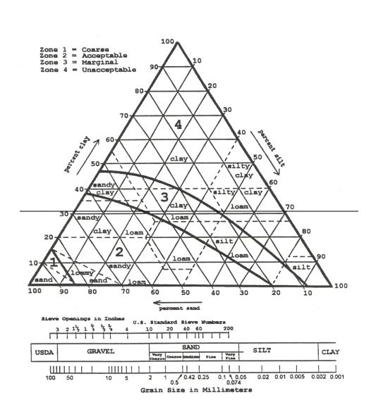
Figure 4-2 SOIL PERCOLATION SUITABILITY CHART FOR ON-SITE WASTE TREATMENT SYSTEMS
